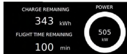
Fig. 18 ESS Status Display
